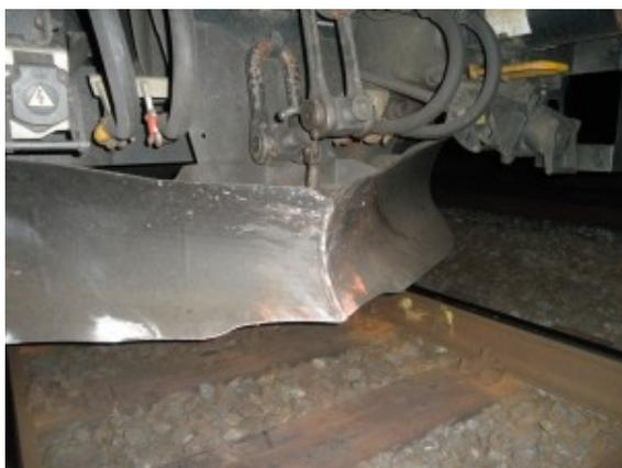
Der Schienenräumer am Triebfahrzeug wurde beschädigt. Foto: Bundespolizei
