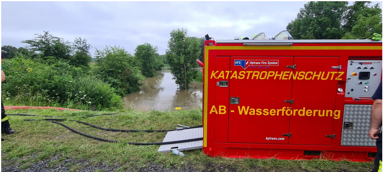
Hochleistungspumpe im Einsatz auf Velmede. Foto: Feuerwehr Bergkamen
