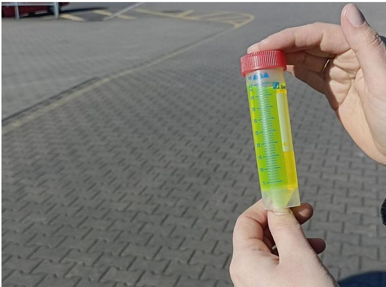
Durch die Zugabe des Farbstoffes Uranin in die Versorgungsleitungen wird turnusgemäß das Fernwärmennetz in Bergkamen der GSW überprüft. Foto: GSW
