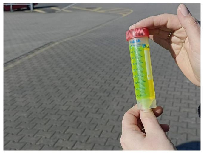
Durch die Zugabe des Farbstoffes Uranin in die Versorgungsleitungen wird turnusgemäß das Fernwärmenetz in Bergkamen der GSW überprüft. Foto: GSW
