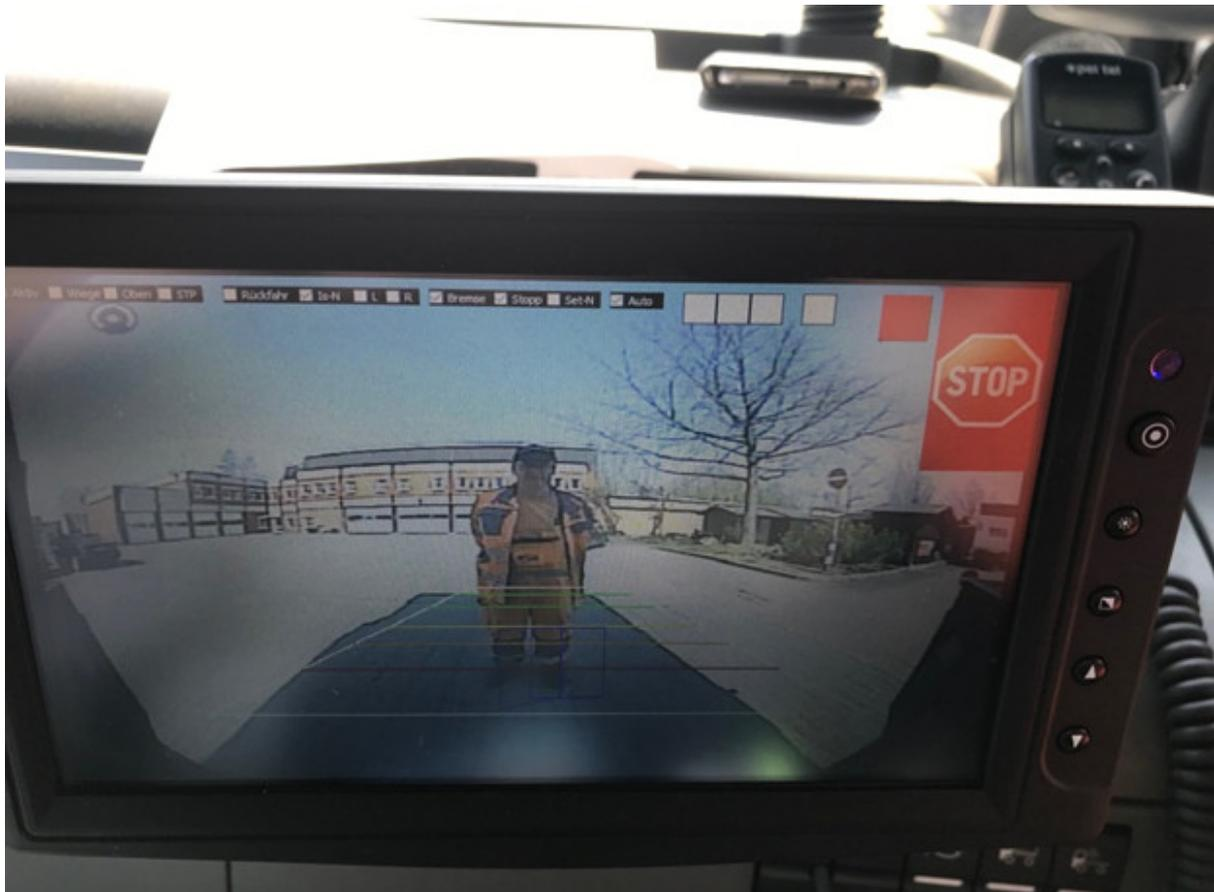
Eine Rückfahrkamera erhöht die Sicherheit der Müllfahrzeuge.
