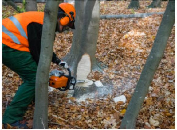
Der Kastenschnitt und der richtige Schnitt beim Keil für die Fällrichtung: Alles will gelernt sein.
