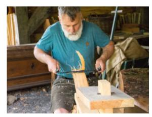
Dachschindel aus Holz entstanden abseits des Experiments.
