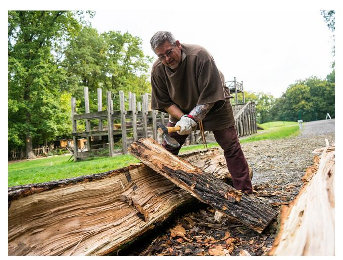
Mühsame Handarbeit ist die Herstellung der Dachschindel – angefangen beim Baumstamm.
