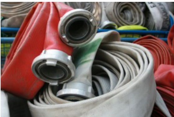
Zusammengerollte Feuerwehr-Schläuche im Feuerwehr-
