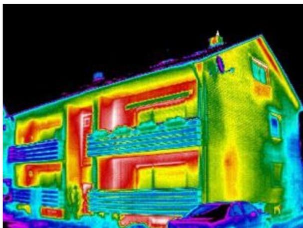
Mit der Erstellung einer Gebäudethermografie kann vor der Durchführung von Sanierungsmaßnahmen an einer älteren Immobilie festgestellt werden, in welchen Bereichen des Objektes hohe Energieverluste auftreten bzw. welche Maßnahmen sinnvoll oder dringend erforderlich sind. Darüber hinaus ist die Methode für Neubauten und bereits renovierte Altbauten als Kontrollinstrument interessant, um den energetischen Stand der Immobilie zu prüfen.
