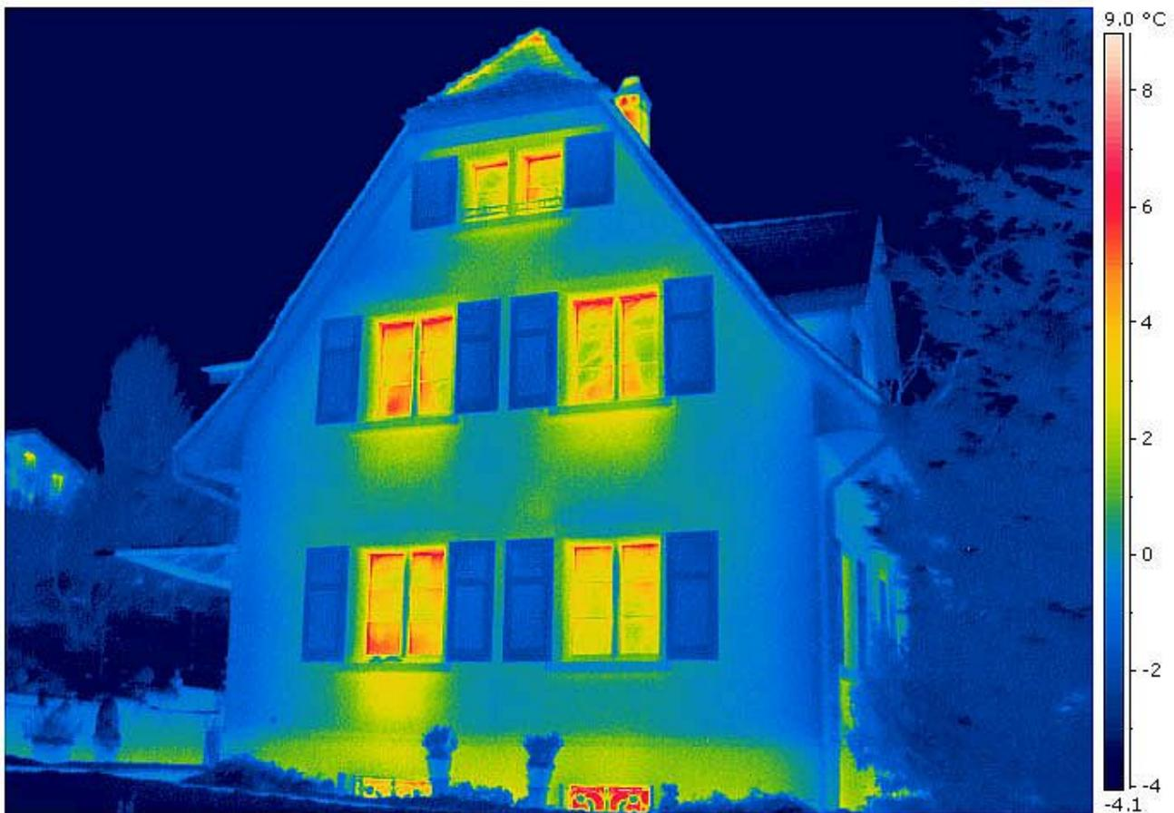
Damit die Energie dort bleibt, wo sie benötigt wird: Die GSW bieten wieder die sogenannte Gebäudethermografie an. Mit Hilfe von Infrarotbildern lassen sich mögliche Energie-Schwachstellen in Gebäuden aufzeigen. Foto: GSW
