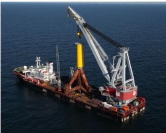
Das Schwerlastschiff Stanislaw Yudin transportiert den letzten der insgesamt 40 Tripods zum Baufeld.
