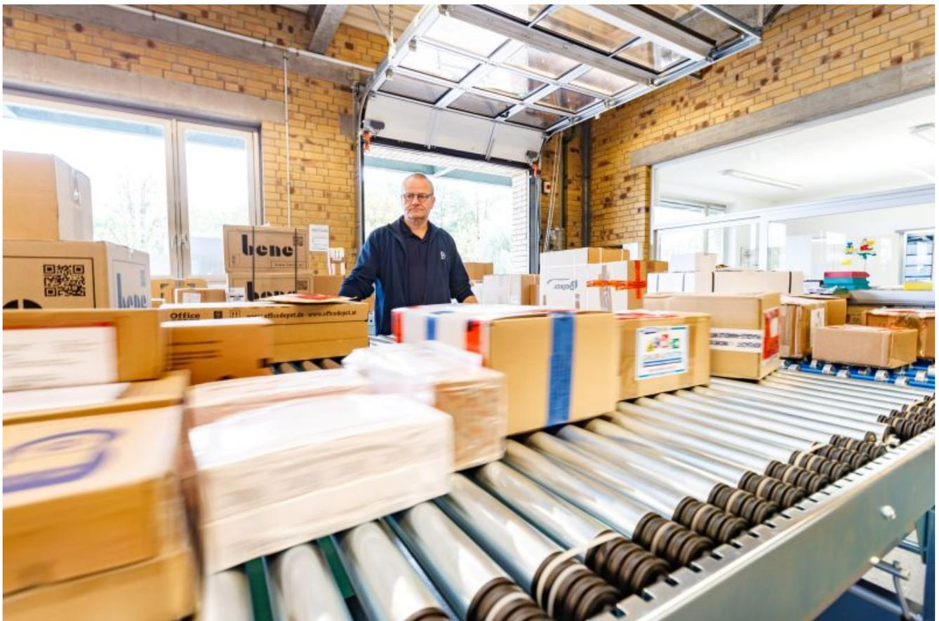
Detlev Gloger demonstriert: Die Bänder sind mit leichtgängigen Rollen und elektronischem Antrieb ausgestattet, so dass das Verteilen der Pakete nur noch minimalen Kraftaufwand erfordert. Foto: Bayer
