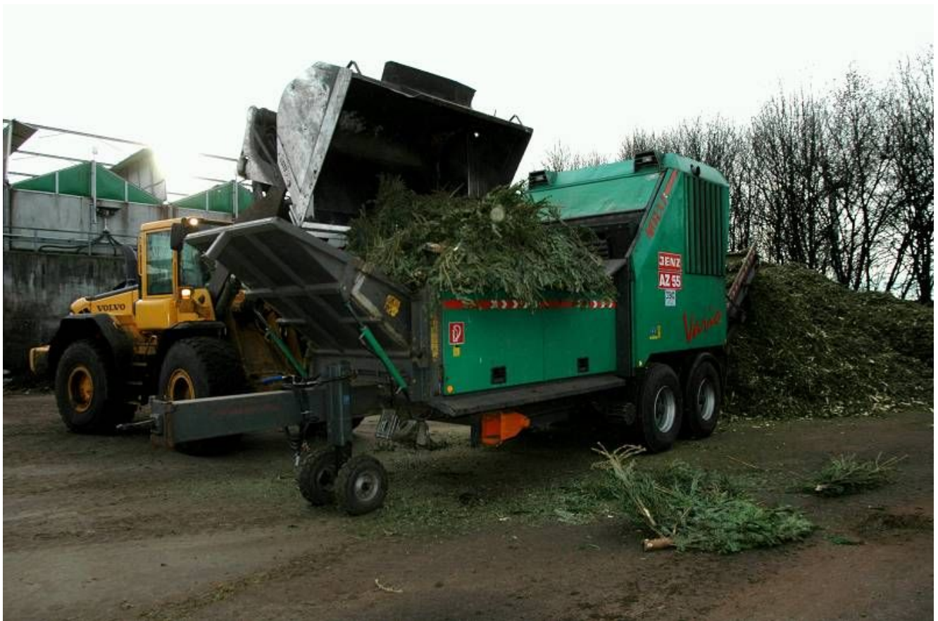
Schredderanlage in Ostbüren. Foto: GWA
