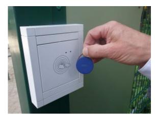
Das Tor zur Fahrradstation wird mit einem Chip geöffnet.
