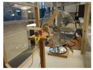
Ein kleines Windrad aus Holz wird im Windkanal getestet.
