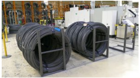
Große Drahtrollen: das Rohmaterial für die Schrauben.
