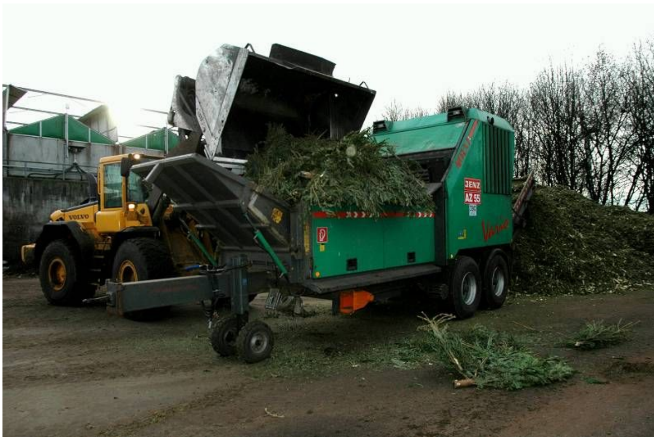
Schredderanlage in Ostbüren. Foto: GWA
