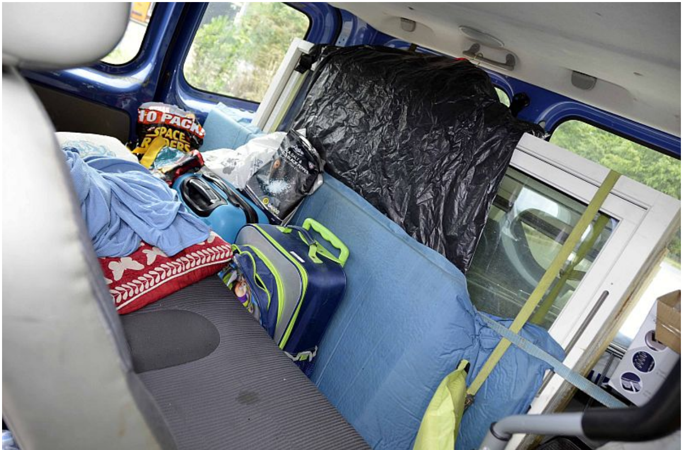
Kaum gesicherte Ladung auf der Rückbank eines Pkw.
