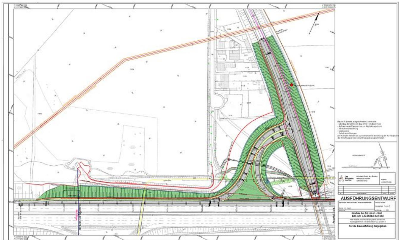
Der Bau der neuen, vollwertigen A2-Anschlussstelle Lünen-Süd geht in den zweiten und finalen Bauabschnitt. Dieser beinhaltet ab Donnerstag (30.9.) die Verbreiterung der Richtungsfahrbahn Oberhausen zur Einrichtung der Verzögerungs- sowie der Beschleunigungsspur, den Neubau der Lärmschutzwände sowie die Anpassung von Verkehrszeichenbrücken und Verkehrszeichen-Halterungen inklusive der angepassten Blaubeschilderung. Zudem wird eine neue Entwässerung hergestellt.
