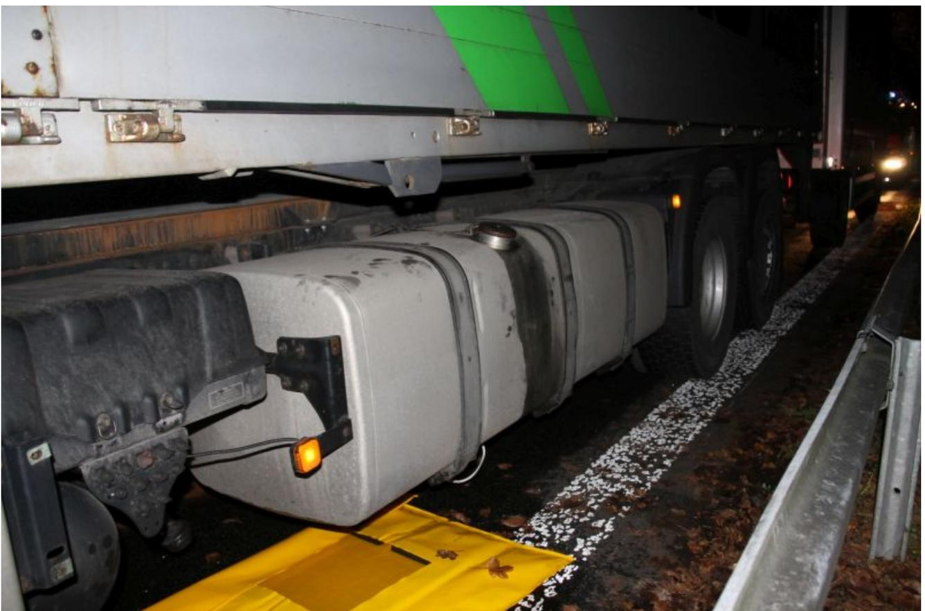
Zunächst wurde der auslaufende Diesel mit Spillbags aufgefangen, bevor die Leitung provisorisch abgedichtet wurde.
