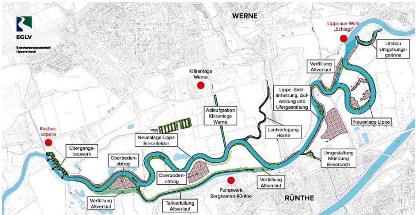
Im Rahmen des Programms „Lebendige Lippe“ plant der Lippeverband gleich mehrere Maßnahmen am Gewässer zwischen Werne und Lünen. Durch Laufverlängerungen, die Schaffung von Auen und das Anheben der Sohle setzt der Wasserverband im Auftrag des Landes NRW die Wasserrahmenrichtlinie um. Grafik: EGLV
