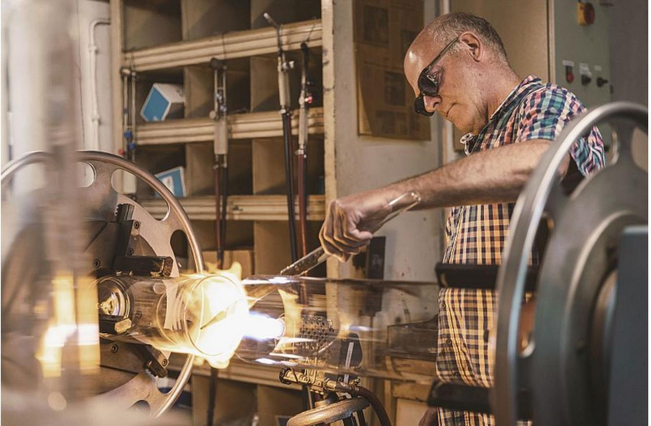
An der Drehbank bearbeitet Hans-Joachim Köbke größere Glasgeräte. Hier erhält ein 10-l-Gefäß einen neuen Boden.
