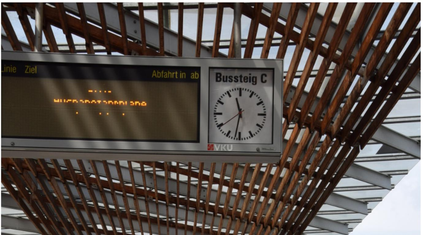
Seit 2004 gibt es diese sogenannte dynamische Fahrgastinformation (DFI) am Bergkamener Busbahnhof. Was bedeutet DFI überhaupt? Die DFI ist eine elektronische Anzeigentafel, die die Abfahrtzeiten der Busse, die Liniennummer und die Fahrtrichtung angeben. Die vorhandenen LEDs haben ihre maximale Lebensdauer mittlerweile erreicht, so dass es immer wieder zu Problemen in den Anzeigen kommen kann.
