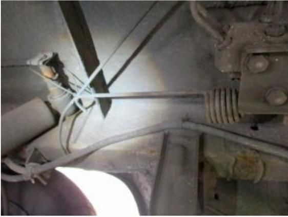
Bremskraftregler mit Kabelbinder fixiert.
