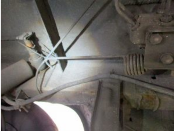
Bremskraftregler mit Kabelbinder fixiert.
