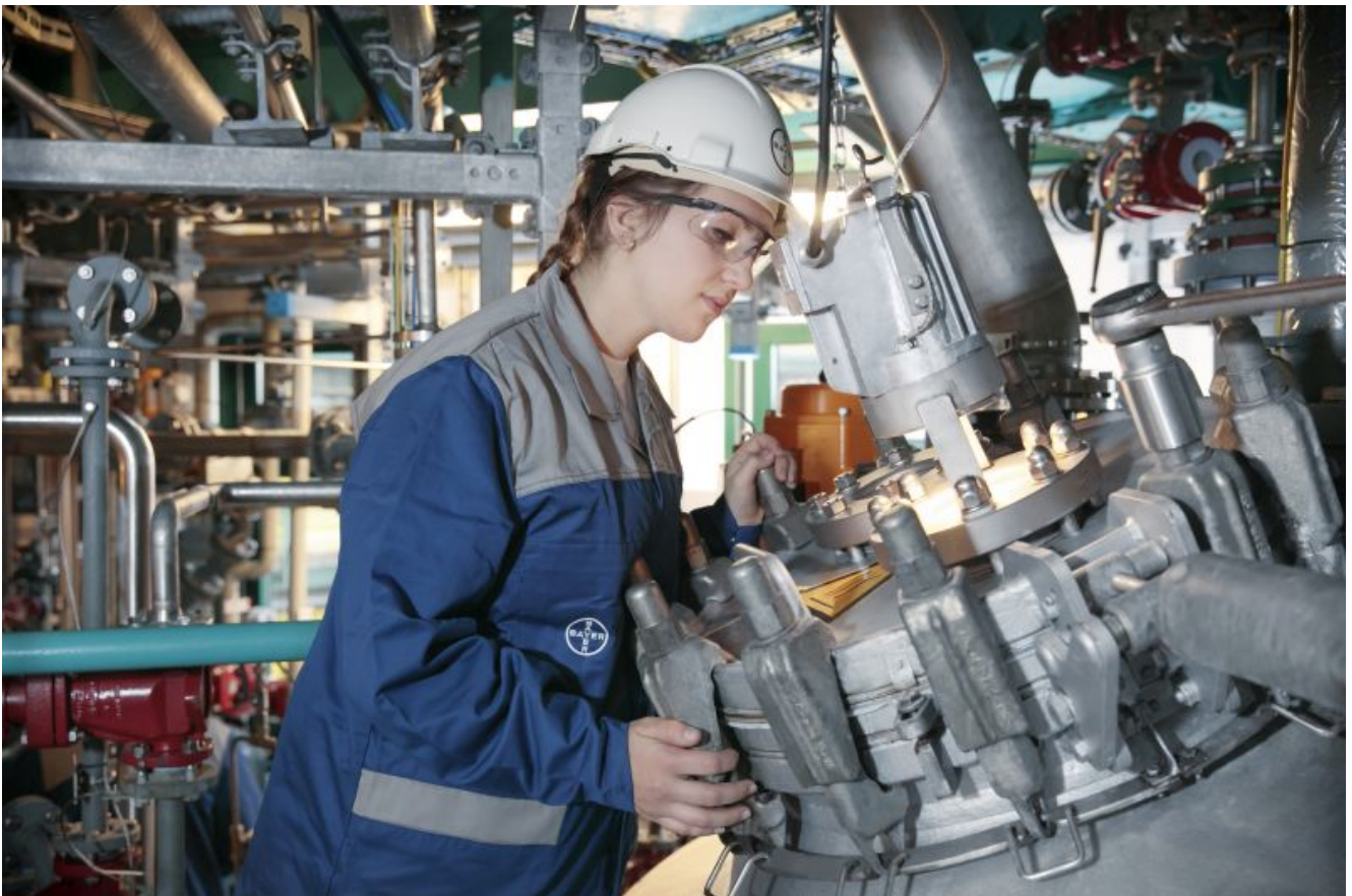
Gina Rosenthal, Mitarbeiterin des Kontrastmittelbetriebs, bei der routinemäßigen Kontrolle eines Rührwerks
