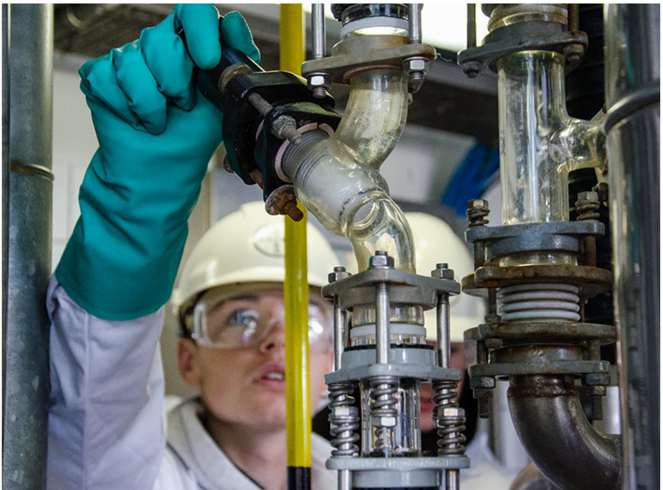
Hochkonzentriert am Ventil, mit dem der pH-Wert neutralisiert wird.
